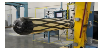
Processo di produzione di un serbatoio in composito tramite filament winding PORH2- D.2.3.7.1 (ENEA)
