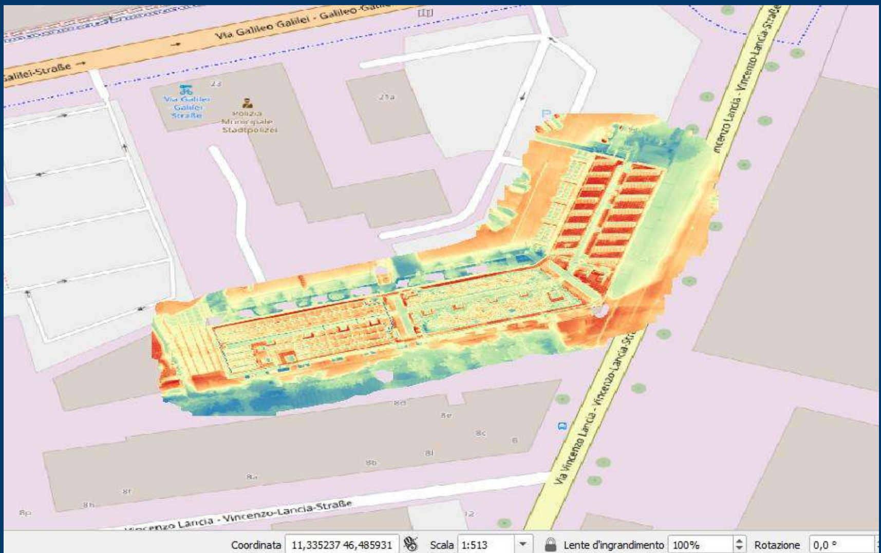
Fotopiano termico del tetto di Via Lancia nelle ore pomeridiane
